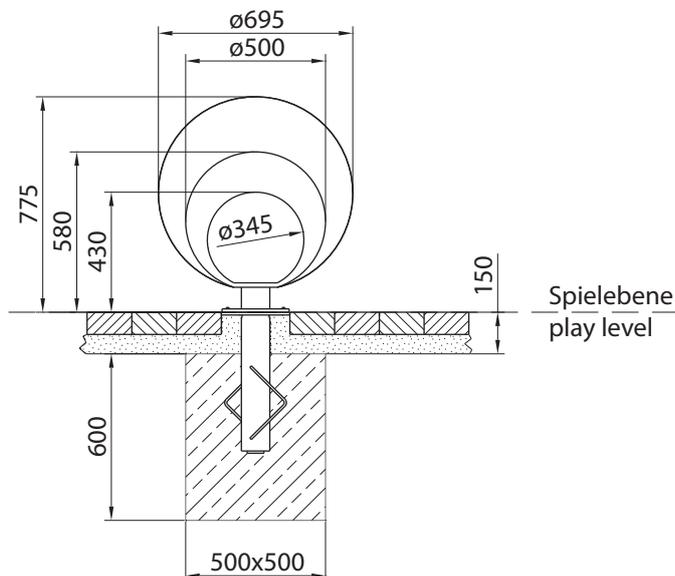
B) Montage mit 400 mm Fundamentüberdeckung in losem Fallschutz
