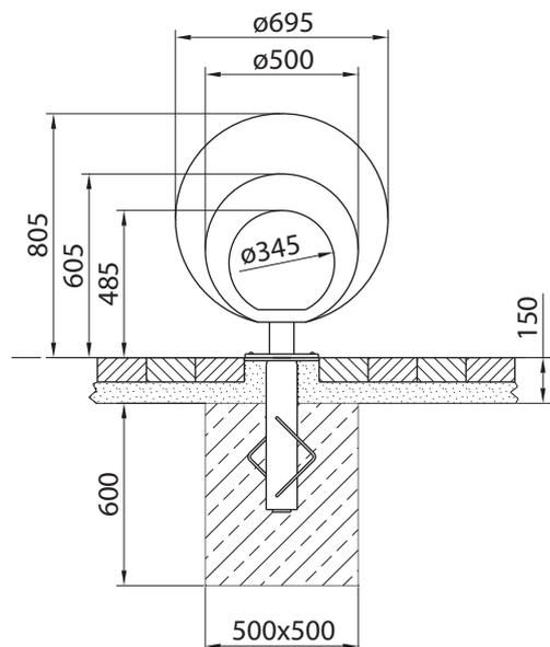
B) Montage mit 400 mm Fundamentüberdeckung in losem Fallschutz
